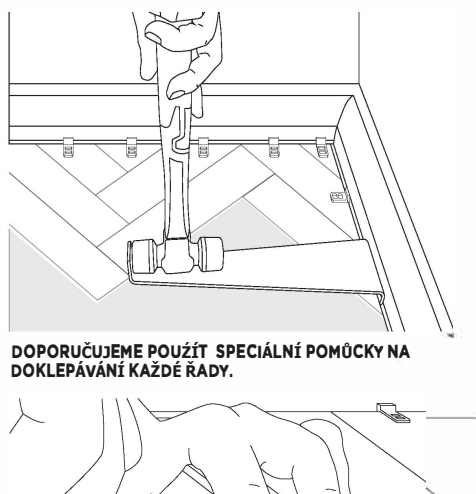
12 Teď pokračujte ve směru zleva doprava a zaklikávejte pouze lamely A. Krátká strana lamely A, která je u startovacího trojúhelníku by měla být mezi čarami, které jste si nakreslili na podklad. poslední lamelu u pravé zdi si naměřte a zkráťte, nezapomeňte na dilatační spáru 6mm u zdi. Na obkreslení úhlu 45° můžete použít již seříznutou lamelu z minulé řady.
